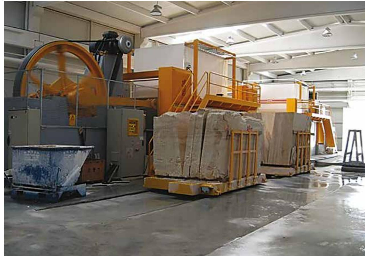
Il telaio può essere fornito con entrata frontale o laterale del carrello
