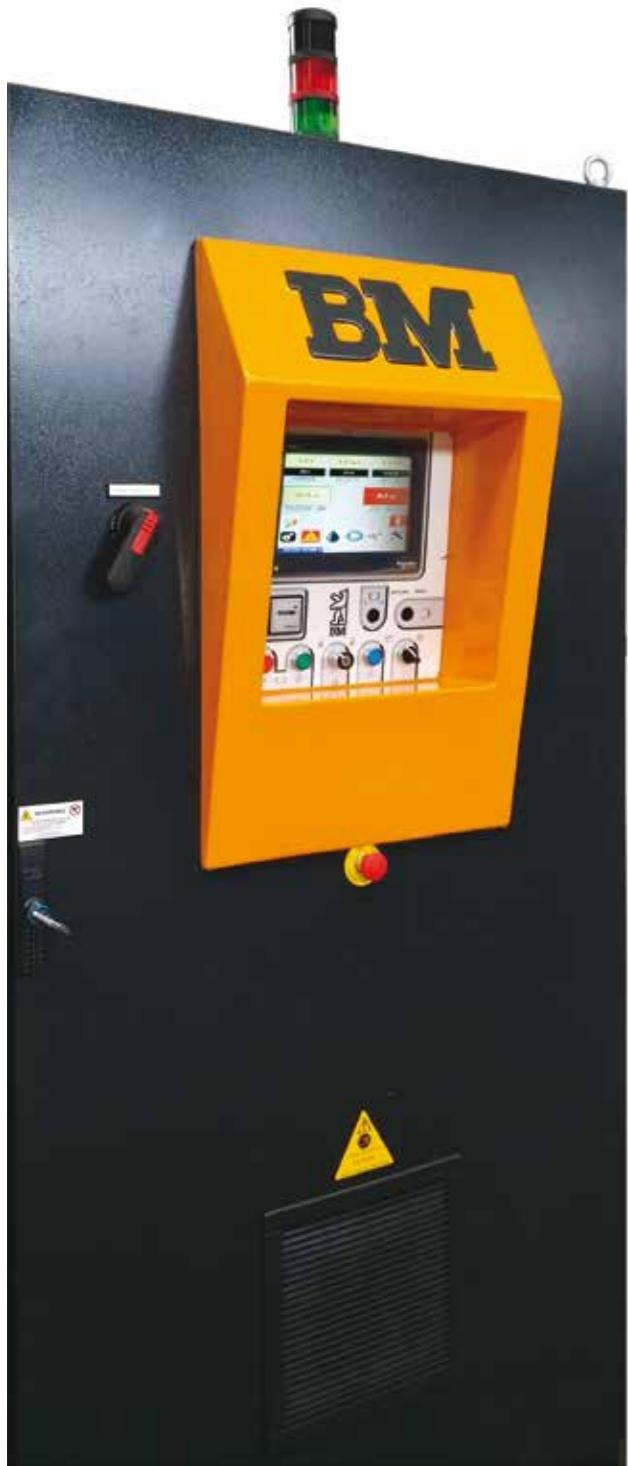
Tutti i componenti elettrici sono standardizzati e delle migliori marche internazionali. Il quadro comandi è dotato, di serie, di automatismi che garantiscono il perfetto funzionamento della macchina anche in assenza dell'operatore. Il quadro può essere dotato di programmatore elettronico per l'autoregolazione della cala secondo il tipo di materiale.
